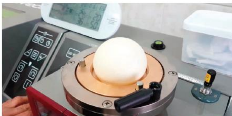
Burbuja de deformación de la masa durante el método internacional normalizado ISO-27971-2015.
